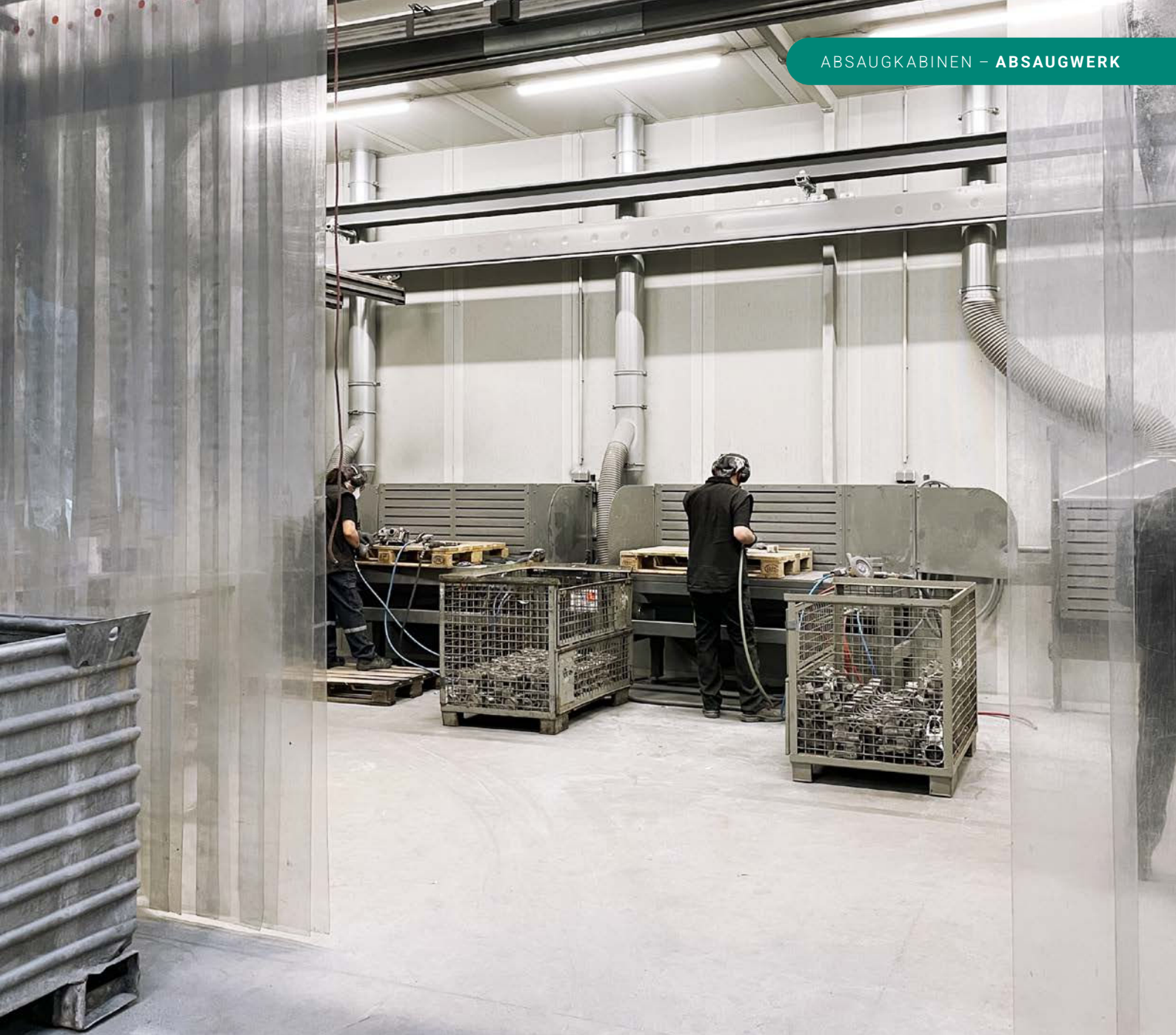
Schallgeschützte Schleifkabine mit integrierten Absaugtischen zur sicheren Erfassung von explosivem Aluminiumstaub (ATEX)
