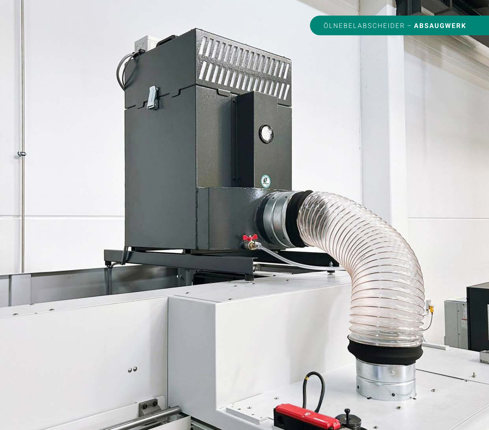
Kompakter Ölnebelabscheider mit 0,5 kW Leistung auf Werkzeugmaschine
