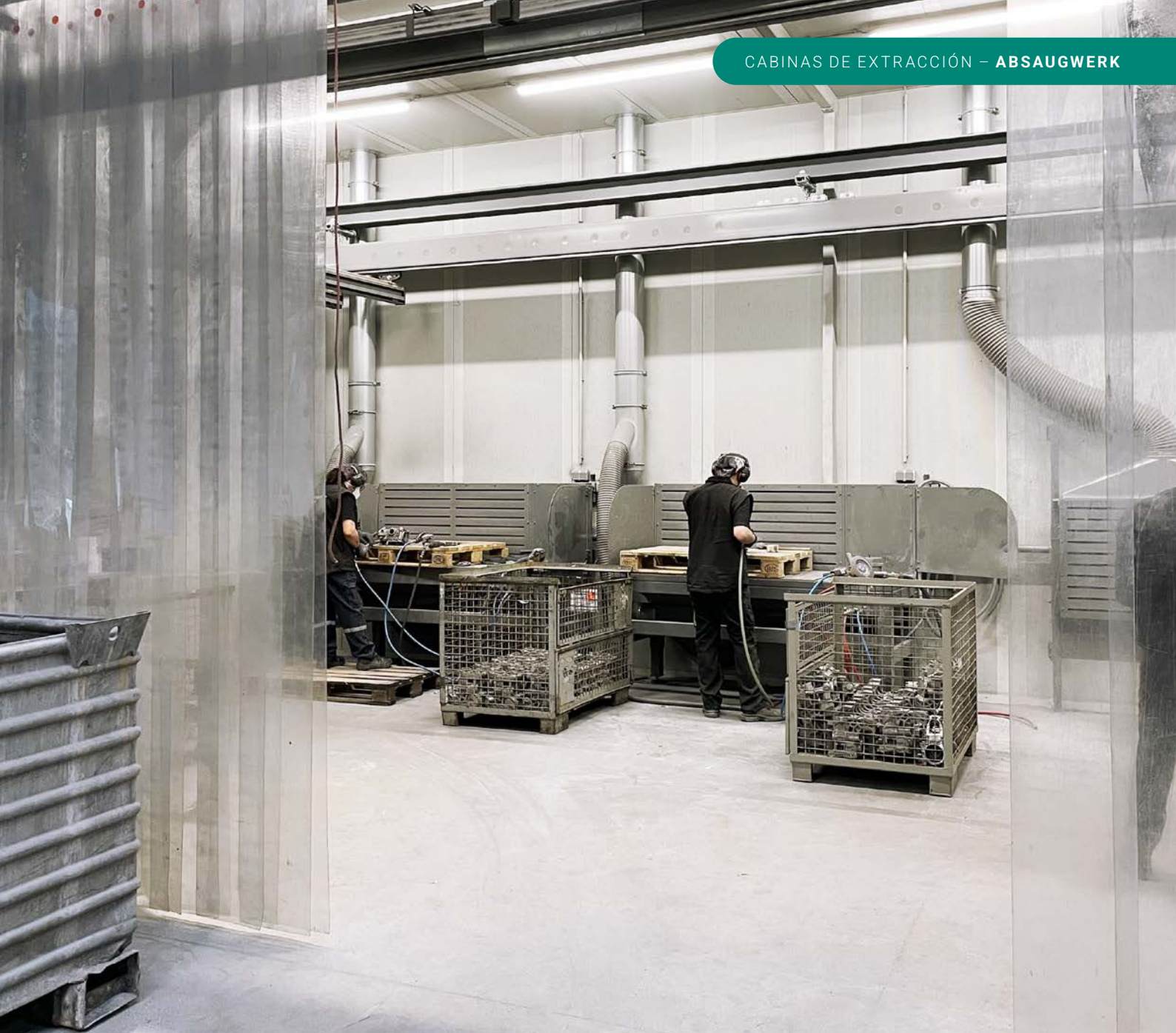
Cabina de rectificado insonorizada con mesas de aspiración integradas para la captación segura de polvo de aluminio explosivo (ATEX)
