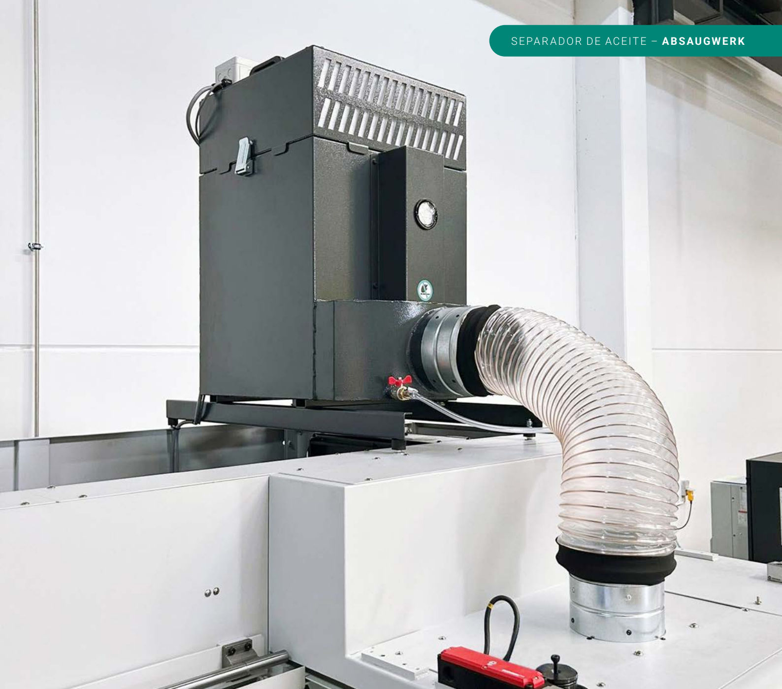
Separador de aceite compacto con 0,5 kW de potencia en máquina herramienta
