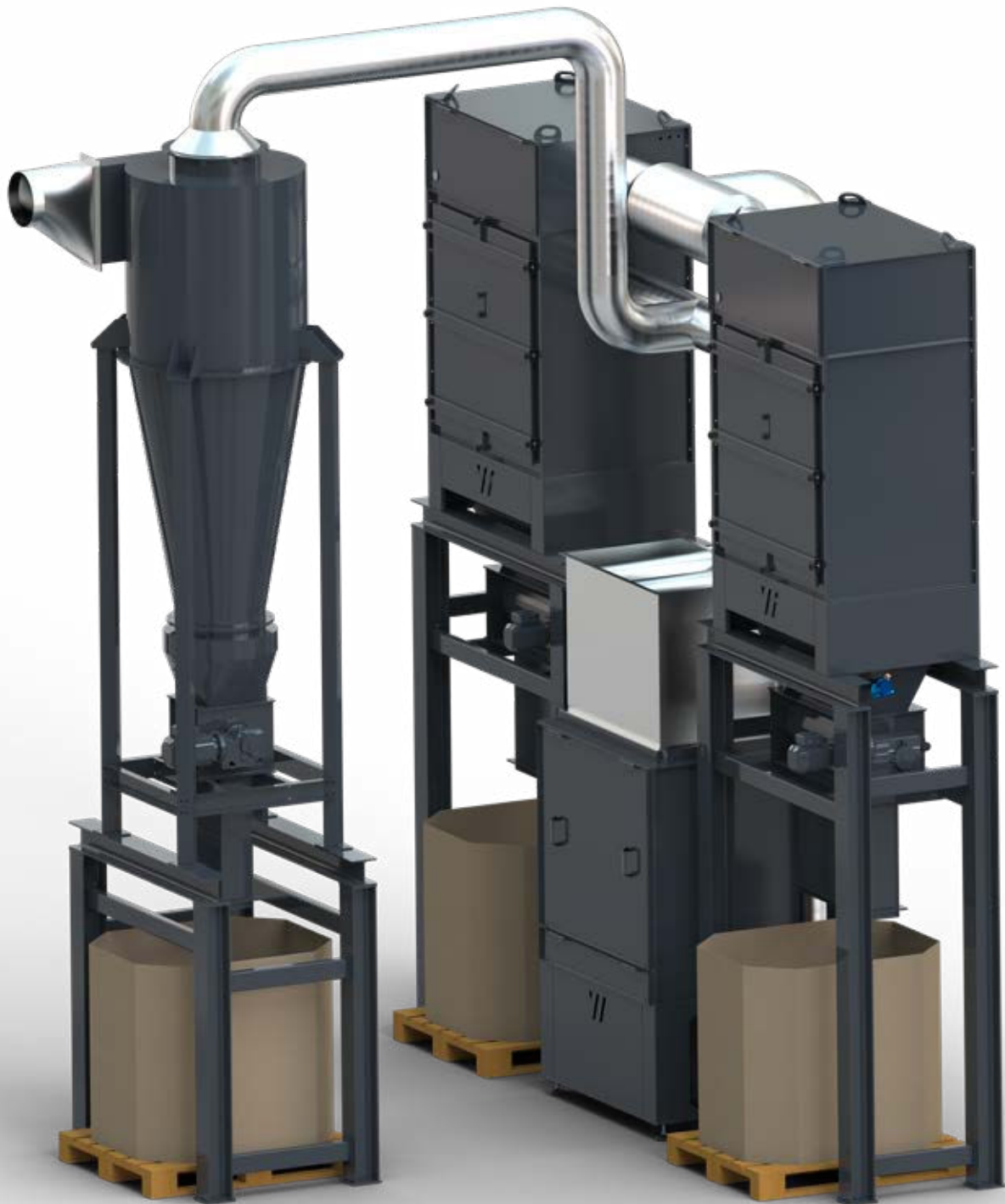
Entstauber mit separatem Zyklonvorabscheider Automat. Austrag über Zellenradschleuse
