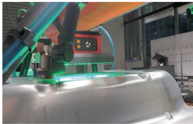
Eine „evoVIU“ Kamera bei der Detektion von Rissen an einem tiefgezogenen Bauteil
