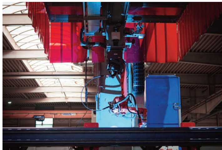
Der Schweißrauch wird in der Haube erfasst und durch eine Absauganlage gefiltert.
